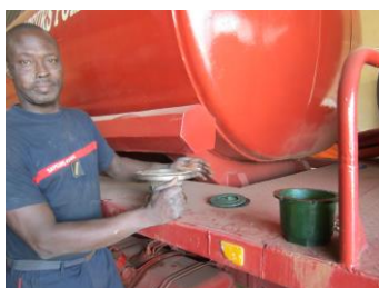
A gauche : Fabrication du clapet anti retour
